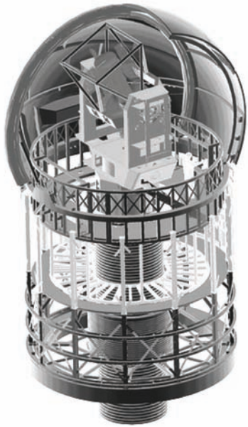
► กล้องโทรทรรศน์ PanSTARRS (Panoramic Survey Telescope and Rapid Response System) ซึ่งทำงานโดยใช้แผ่นกระจกวางเรียงกันเป็น mosaic เพื่อค้นหาดาวเคราะห์น้อยที่จะพุ่งชนโลก กล้องนี้ตั้งอยู่ที่เกาะฮาวาย
